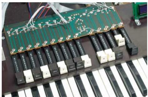
Zwei dieser Folien-Drucksensoren rechts und links unter der Tastatur vermitteln dem MIDIVice über ihre Widerstandsänderung ein Maß über den Tasten-Nachdruck (Aftertouch). Damit der Anpressdruck gleichmäßig über die Sensorfläche verteilt wird, haben wir kleine Gummi-Gehäusefüße unter das Tastatur-Chassis geklebt. Die Analog-I/O-Platine (unten) wird erst nach dem Einbau der Sensoren abgeglichen.
